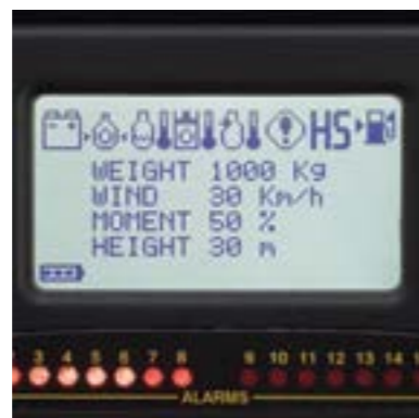
2,7'' LCD Display (128x64 Pixel) für AJR, AJM
