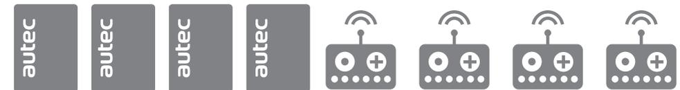
Ein Mehrfachsystem besteht aus mehreren tragbaren Sendeeinheiten (2 bis 4) über die die Bediener eine oder mehrere Maschinen fernsteuern können und aus mehreren Empfangseinheiten (2 bis 4), die an den Maschinen installiert sind. Die Empfangseinheiten können von einer oder mehreren Sendeeinheiten gesteuert werden, jedoch nacheinander, unabhängig und exklusiv.
