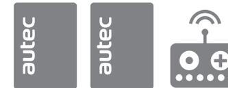
Ein Mehrfachempfangssystem besteht aus einer tragbaren Sendeeinheit über die der Bediener eine oder mehrere Maschinen steuern kann und aus mehreren an den Maschinen installierten Empfangseinheiten. Die Anzahl der Empfangseinheiten hängt von der Kundenanwendung und der Funkverbindung ab. Sollte die Sendeeinheit die Funkverbindung mit mindestens einer der Empfangseinheiten verlieren, hört sie auch mit allen anderen zu arbeiten auf.
